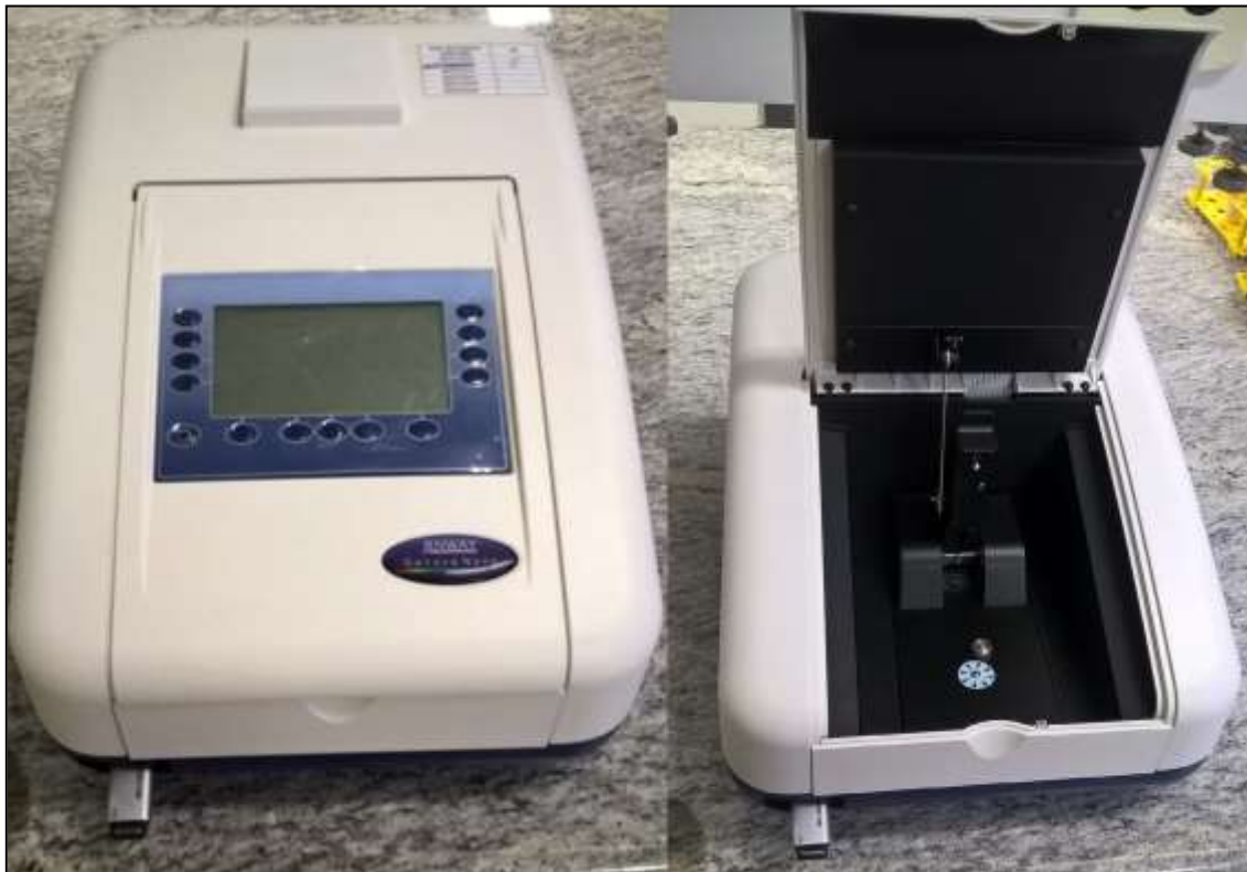
Figura 8. Nano-espectrofotômetro Genova Nano
