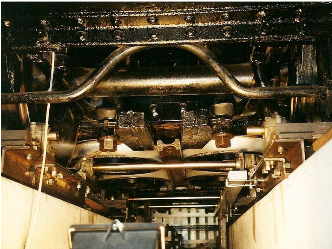
FIGURA 23: Fotografia das engrenagens do chassi de uma locomotiva do sistema Fell. Reparar nas quatro rodas horizontais pressionando o trilho central. Fonte: Fell Locomotive Museum.
