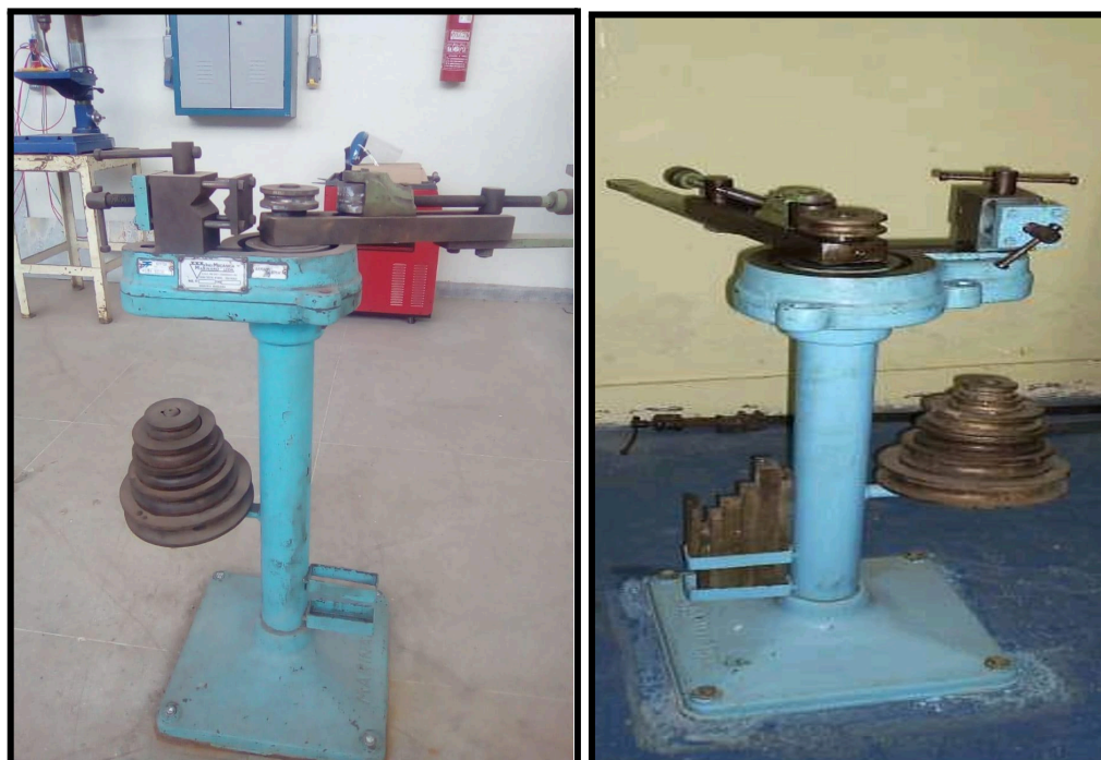
Figura 42 - Curvador de tubos em 2025 e em 2008
