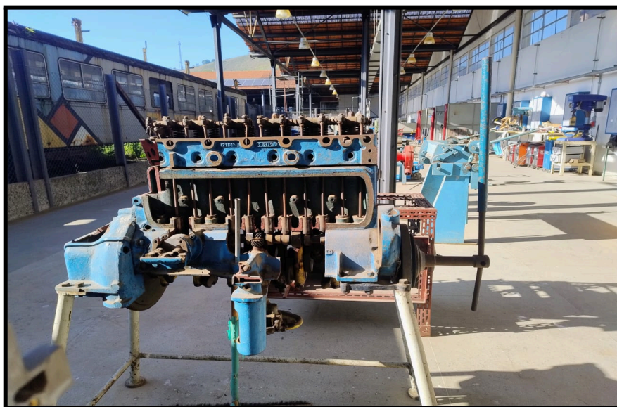
Figura 38 - Motor diesel 6 cilindros demonstrando o funcionamento do motor de Locomotivas
