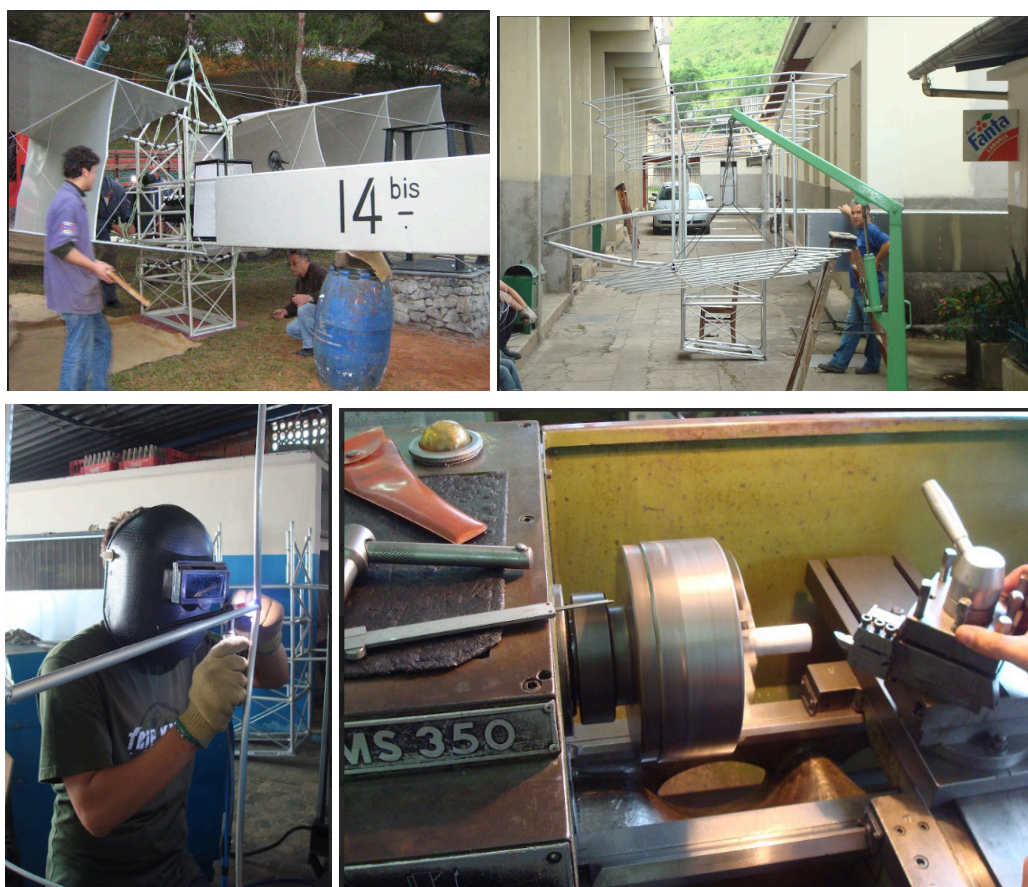
Figura 45 - Torno Mecânico Nardini MS 350 na construção de réplicas do 14 Bis
