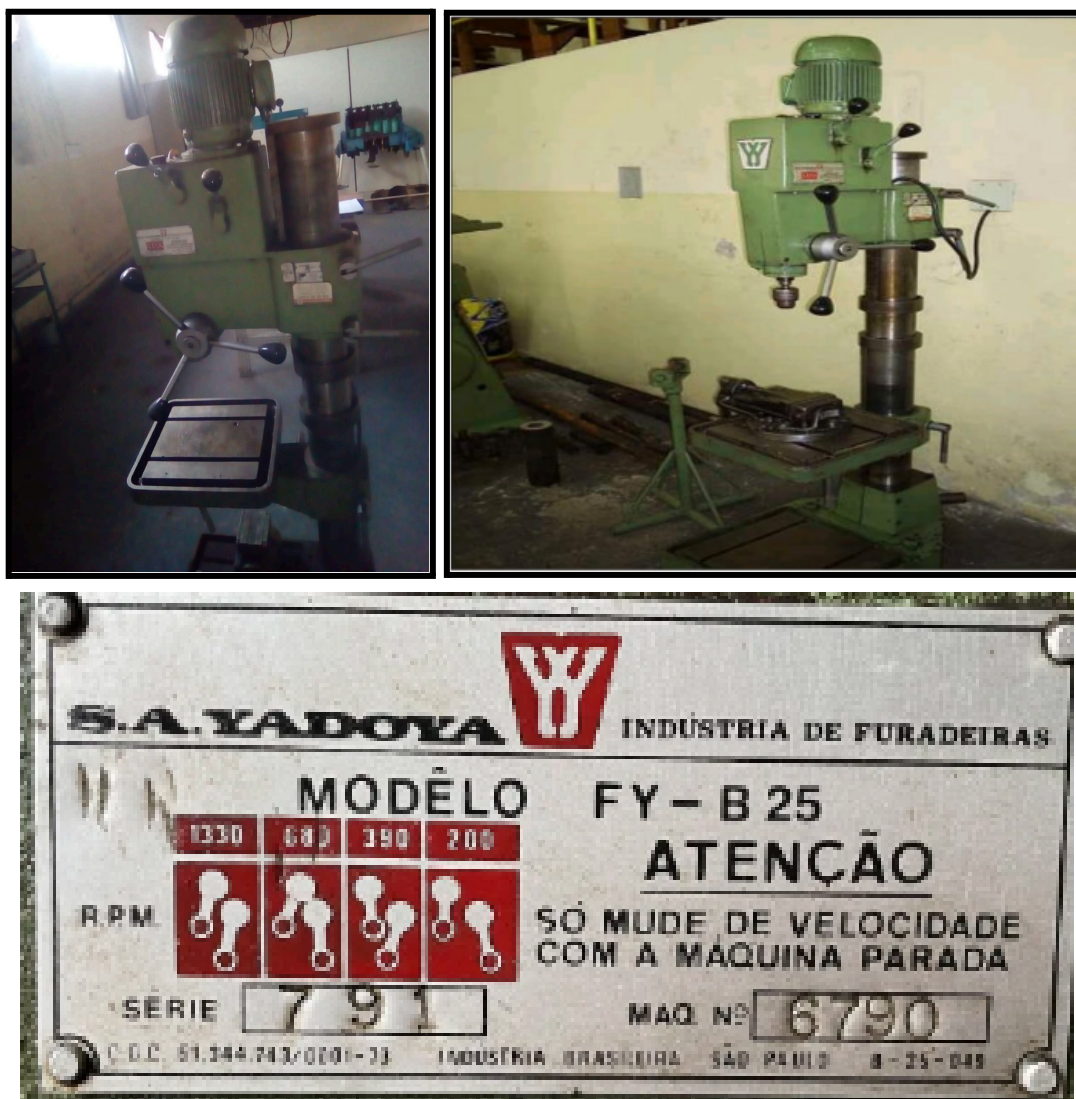
Figura 40 - Furadeira de coluna SA Yadoka em 2025 e 2008
