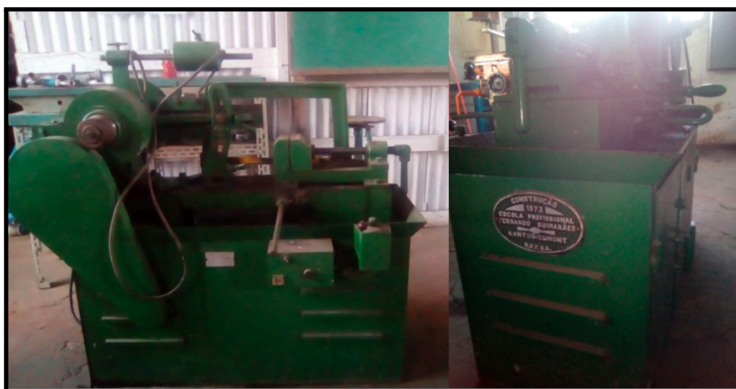
Figura 21 - Serra Mecânica Alternativa produzida pelos alunos da EPFG em 1973
