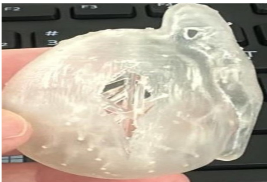
Figura 10 - Demonstração das resinas de sustentação da prótese testicular customizada
