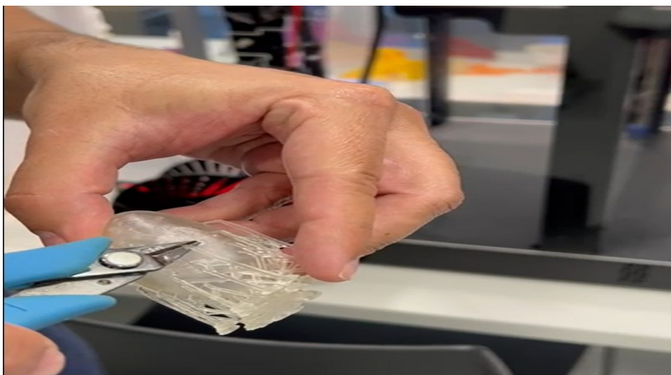
Figura 14 - Retirada do material de sustentação da prótese testicular customizada com alicate
