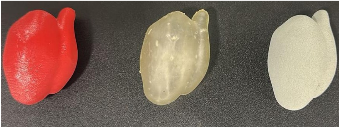
Figura 5 - Impressão 3D do testículo com epidídimo com material PLA, Resina e Flex Bright na sequência
